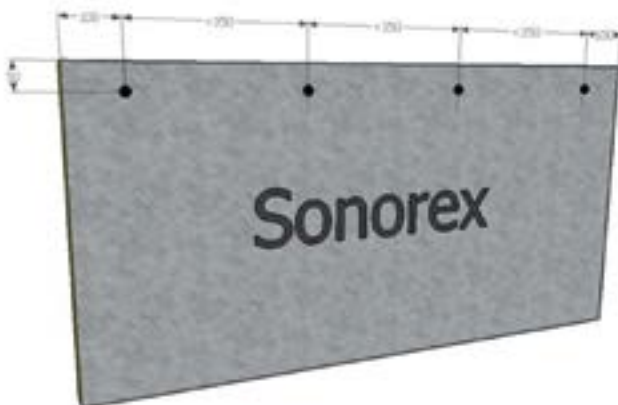
Abb. 1: Platzierung der Sonorex®-Schrauben und/oder der Sicherungsstifte
